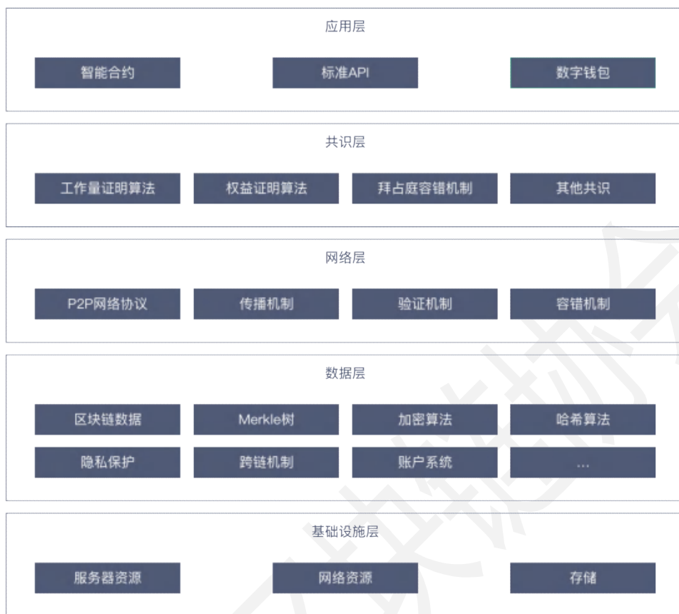
图 2.1 区块链典型体系结构
